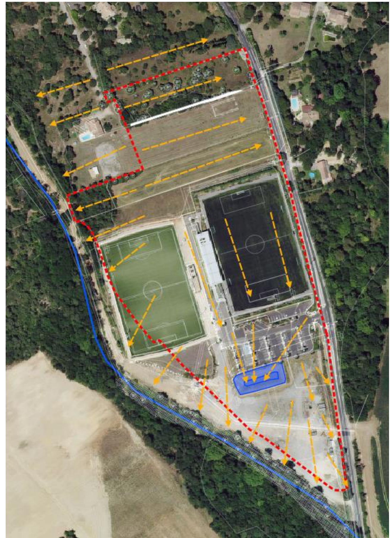
Figure 18 : Représentation schématique de l'écoulement des eaux superficielles
